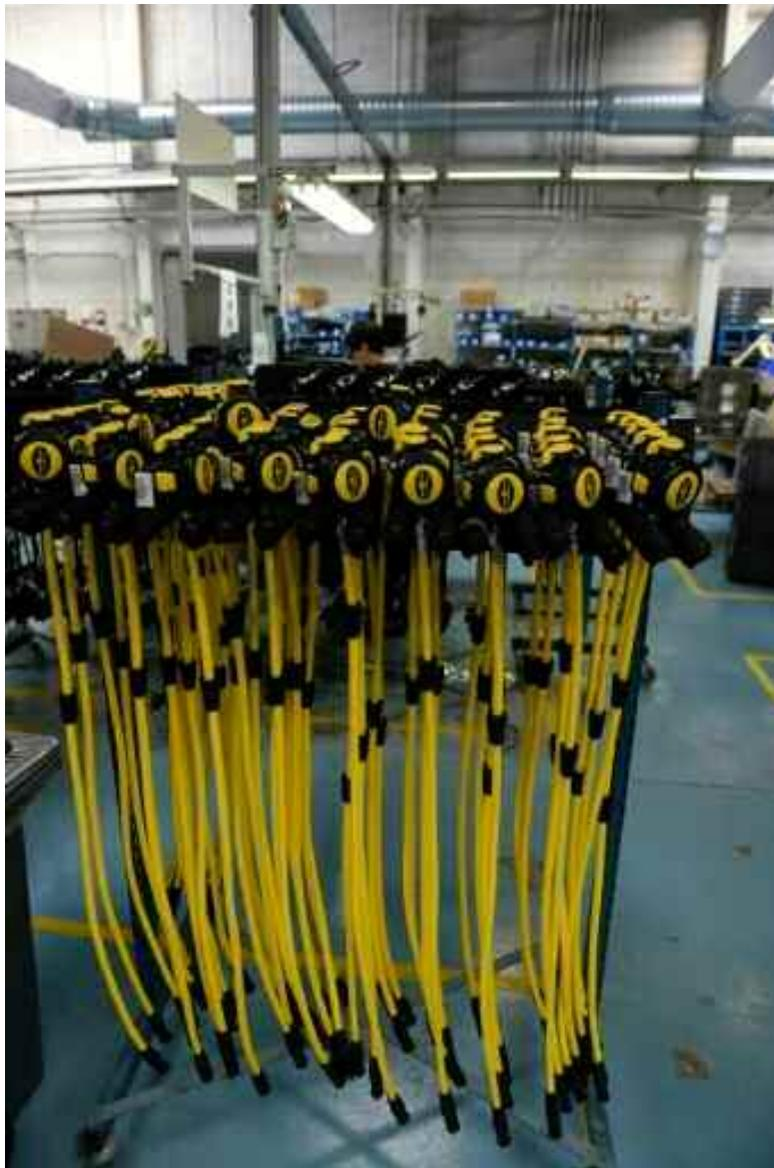
reguladores en proceso de montaje en la fábrica de Aqua Lung
