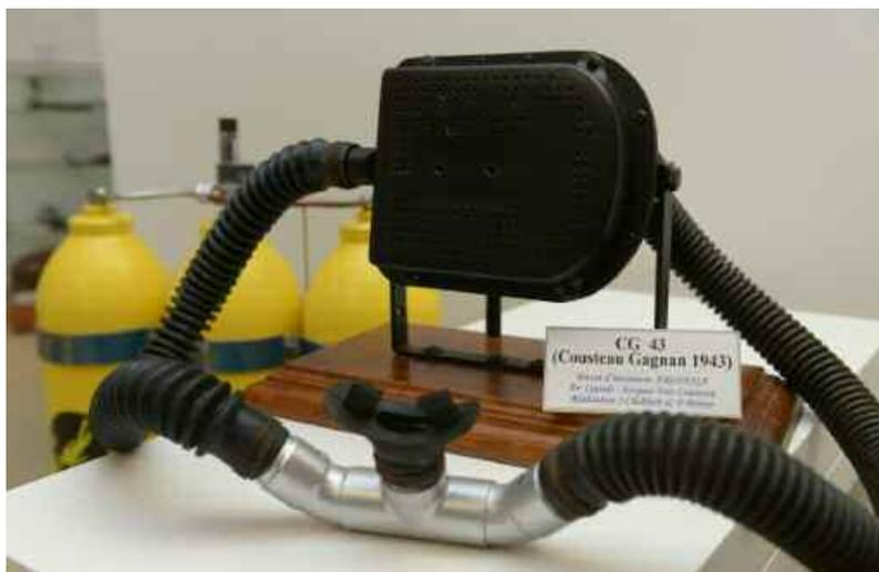
Llamado en un principio, regulador Cousteau-Gagnan, el artilugio compuesto por una boquilla conectada por dos tubos, a una caja negra, se hizo famosa como “Aqua Lung” (pulmón de agua).
