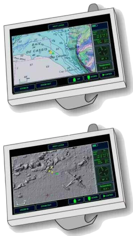
ecuación de la captación de los datos procedentes del satélite. La señal del GPS se amortigua cuando entra en el agua. Nuestra idea ha sido la de concebir una extensión que usa una baliza, en la superficie, equipada con un GPS y después, desarrollar un software que traduce esta señal en ondas acústicas y sin cables”.
